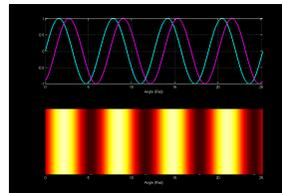
En mesurant cette modulation du temps de propagation il est possible d'estimer la variation de distance subit par chacun des trois 'bras' de LISA au passage de l'onde; on en déduit ses paramètres.
